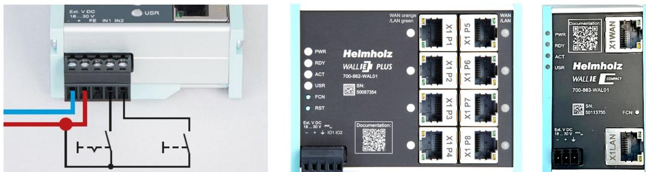
Die RJ45 Buchse „P1 WAN“ des WALL IE (700-860-WAL01) dient zum Anschluss des externen Netzwerks. Die RJ45 Buchsen „P2 LAN—P4 LAN“ sind geschwicht und dienen zum Anschluss des internen Netzwerks.
