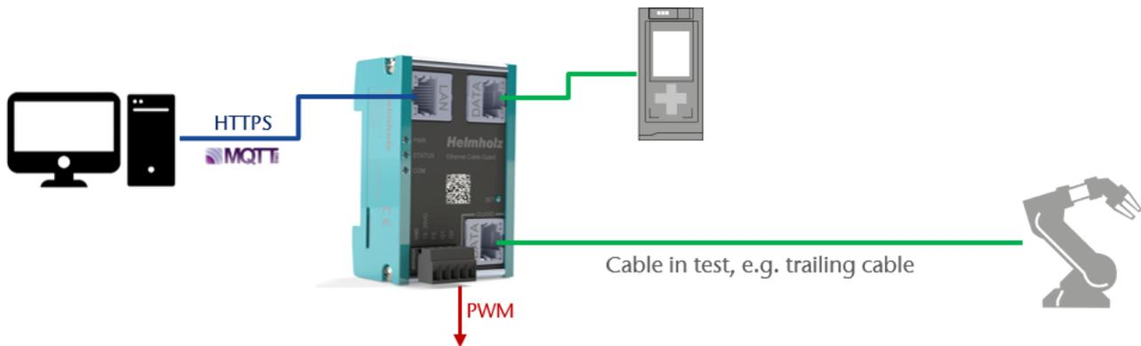
Zur Integration in IIoT Strukturen kann der überwachte Kabelzustand auch via MQTT durch den Cable Guard versendet werden.
