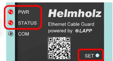
Ist der Teach-In Vorgang abgeschlossen, so leuchtet die PWR und die STATUS-Led dauerhaft grün. Das ist der normale Betriebszustand des Gerätes. Die Überwachung des Kabel ist nun aktiv.
